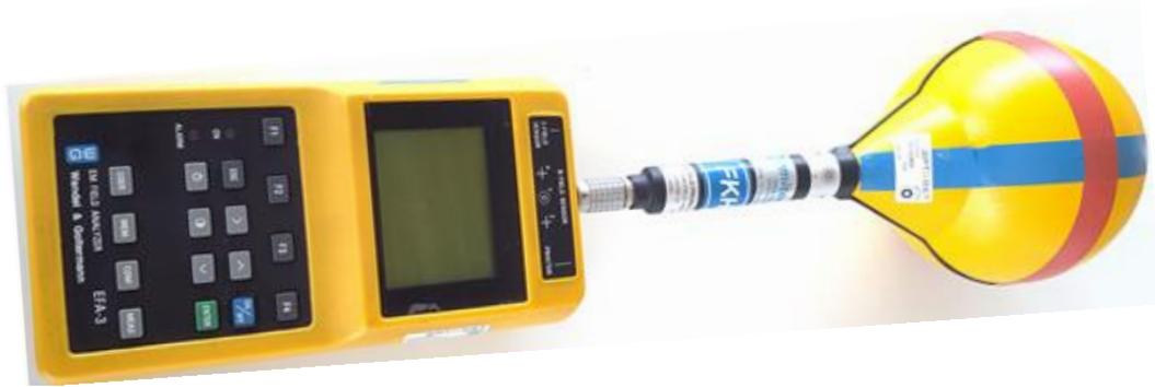
Figure 5-1 Appareil de mesures et sonde utilisés pour le relevé de champ magnétique
